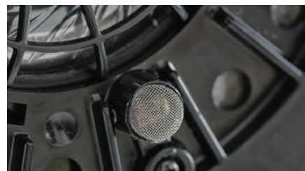
Podwójny układ przetworników – podstawowemu o średnicy 50 mm towarzyszy dodatkowy mały przetwornik umieszczony w tubce.
