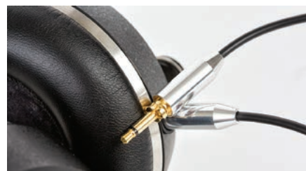
Kable są grube, a wtyki metalowe i ciężkie, każdą muszlę podłączamy 3,5-mm złączem, stabilizowanym zatraskiem.
